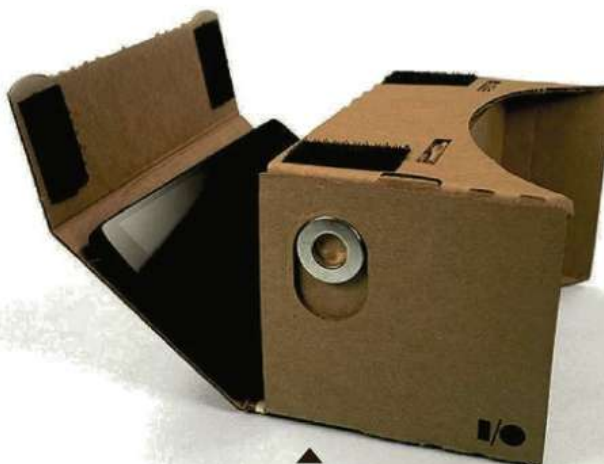
2. Le smartphone se glisse sur l'avant du masque. Un anneau métallique retenu par un aimant permet de cliquer sur les applis.
